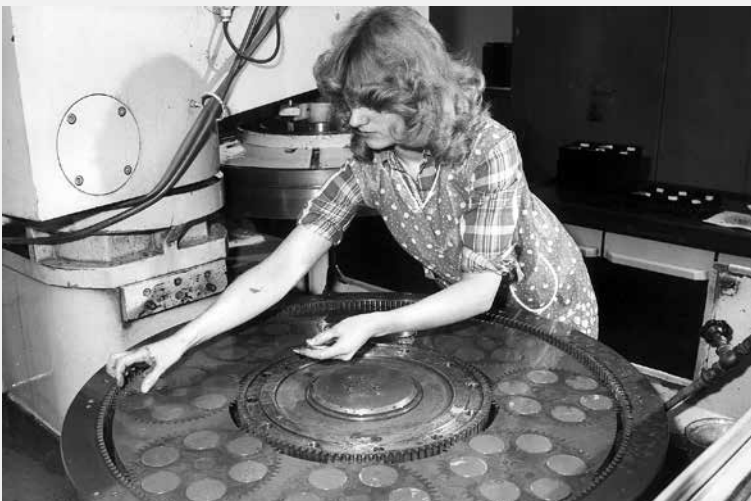
Eine Mitarbeiterin der VEB Spurenmetalle Freiberg bestückt eine Läppmaschine händisch mit Wafern. Bei diesem Prozessschritt werden maschinell die Oberflächen der Wafer geglättet.
